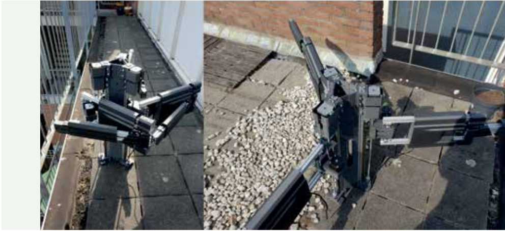
EEN MOBIELE, 3-ARMIGE ROBOT DOOR HET LAB VOOR ADDITIVE MANUFACTURING IN ARCHITECTUR VAN TU DELFT.
